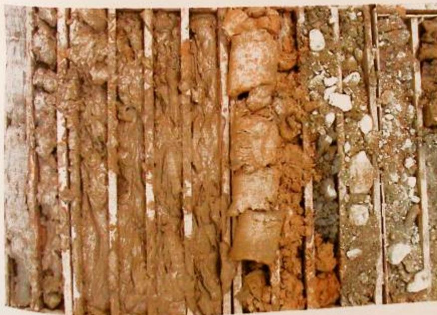
Vzorkovnice části návrtu u sondy VP-5/č. Nadložní vrstvy modrošedých štěrků přecházejí do podložních jílovitých žlutohnědých písků. Od hloubky 8,8 m p.t. jsou již uloženy vrstvy horizontálně a vertikálně proměnlivých písčitých jílu převážně měkké konzistence.
