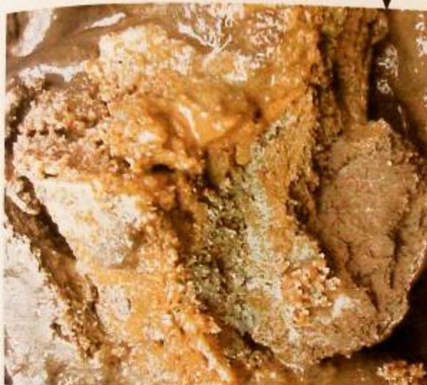
Horizontálně a vertikálně proměnlivé vrstvy převážně písčitého jílu zastižené ve vrtu VP-5/č v hloubce od 8,8 m p.t. v kontrastu s dobře vytríděným převážně křemitým pískem u vrtu VP-2/č v hloubce od cca 9,0 m p.t.
